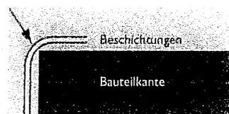
Durch Oberflächenspannung bei Flüssigkeiten ergibt sich stets eine geringere Schichtdicke an Bauteilkanten (Kantenflucht)
